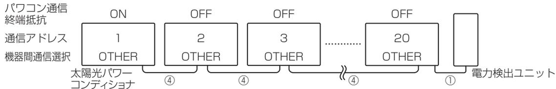
太陽光パワーコンディショナのパワコン通信終端抵抗と通信アドレス、機器間通信選択は、配線図に従って設定してください。
