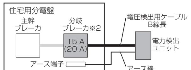
※1 太陽光発電システム専用ブレーカ（または住宅用分電盤）の施工説明書等を確認し、端子の共締めが不可とされている場合は、別途「極数3の分岐ブレーカ」を設置してください。
