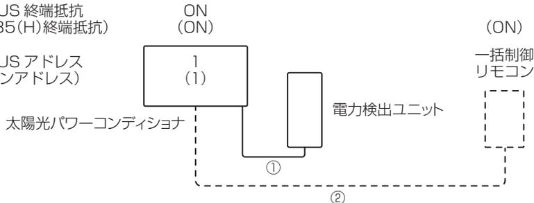
※一括制御リモコン (GP-PM204RM) は、MODBUS コネクタと RS-485(H) コネクタを同時に使用できるパワーコンディショナにのみ接続できます。GPS55C は、MODBUS コネクタと RS-485(H) コネクタを同時使用できません。
